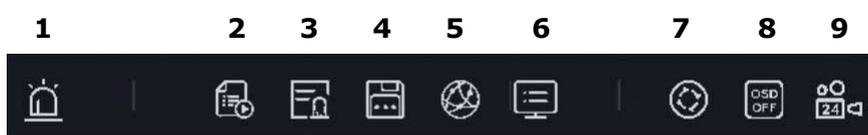
1 – USCITE ALLARME – Mostra lo stato delle uscite di allarme
