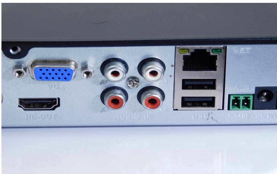
I XVR sono programmati di fabbrica per fornire una risoluzione bassa (1280x1024) in modo da essere compatibili con tutti i monitor. Una volta collegato il monitor e avviato il XVR ti conviene aumentare la risoluzione dell'uscita video fino alla massima supportata del tuo monitor (di regola FullHD 1920x1080 o 4K 3840x2160).
