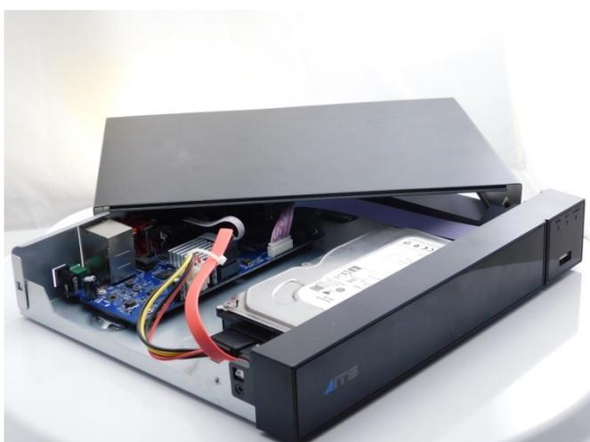
Fissa l'hard disk con le 4 viti fornite che si avvitano da sotto il videoregistratore
