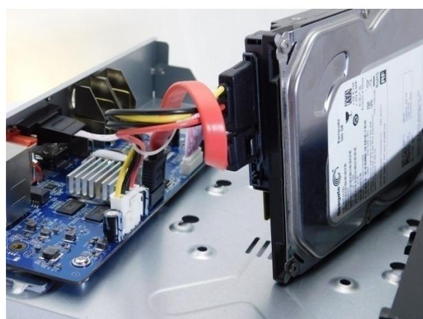
Collega l'hard disk con i due cavi di alimentazione e dati che trovi all'interno. Se ci sono più porte, scegli una coppia qualsiasi.
