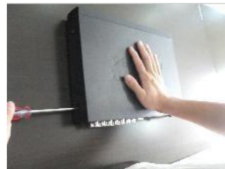
installare le viti su entrambi i lati del guscio
